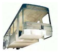
**Composite Monocoque Structure**
